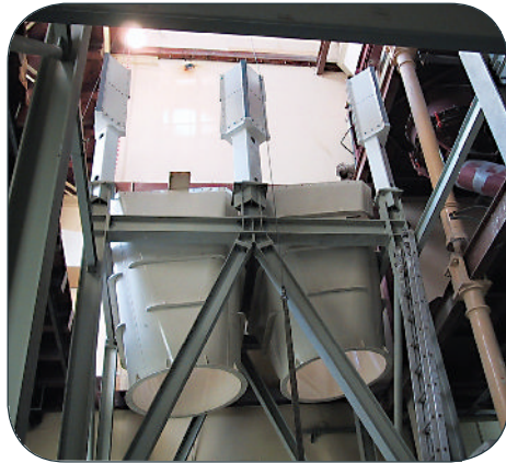
Portugal, Mehl, kohäsiv, 4 Zellen à 40 m 3 und 2 Zellen à 120 m 3
